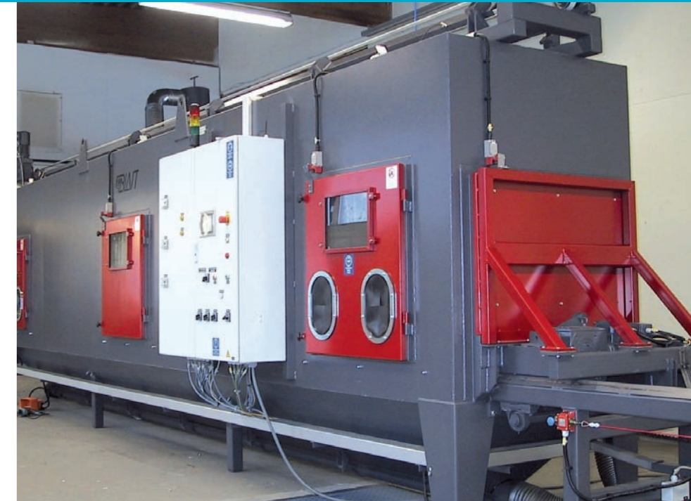
Finnblast Oy:n raepuhalluslaitteisto on maalattu vesiohenteisellä Fontecoat EP 50 -epoksimaalilla.
